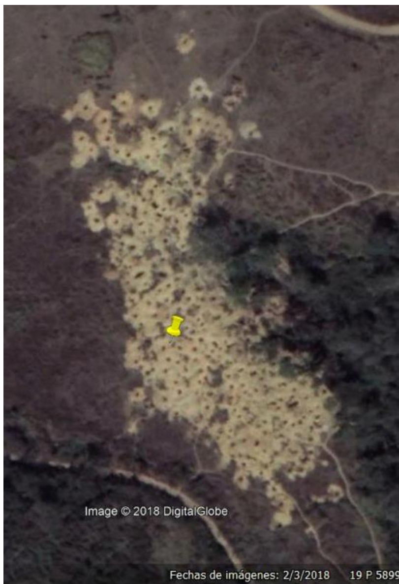
Margen derecha del Río El Torito. Se observan los pozos que realizan los mineros para alcanzar el nivel con grava aurífera.
